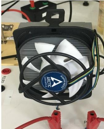
Le dispositif est constitué du **ventilateur** et d'un **dissipateur** (en arrière-plan) et d'une **CTN** pour la mesure de température (voir plus loin). L'ensemble complet ventilateur/dissipateur est vendu sur les sites spécialisés. Le dissipateur ne sert à rien mais modélise l'échangeur de chaleur de la PAC.
